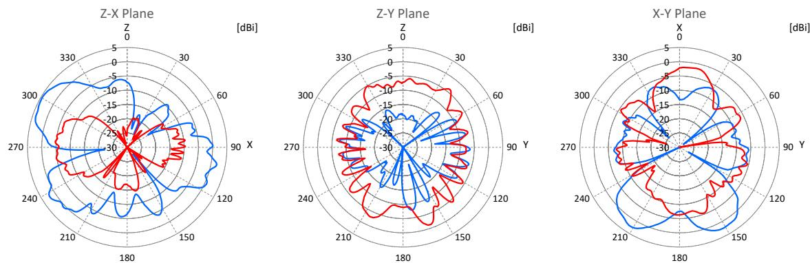
青線 Blue line: 水平偏波 Horizontal polarization
